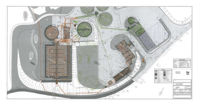
Der rot markierte Bereich soll im ersten Bauabschnitt umgesetzt werden. Insbesondere betrifft das die Erdarbeiten mit Spezialtiefbau, den An- und Umbau Betriebsgebäude, das Belebungsbecken, die Nachklärung II sowie den Rechen und Sandfang.
